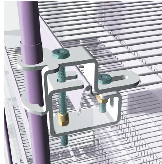
cas typique d'étagère en grille métallique noter la position du boulon+écrou
