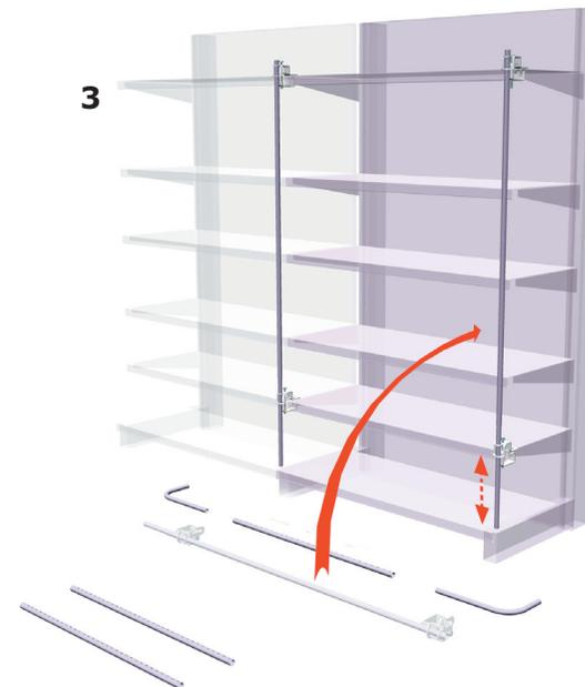
3 poser le 2nd montant pré-assemblé et ajuster la hauteur
