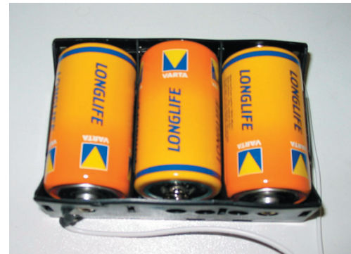
emplacement correct des piles
