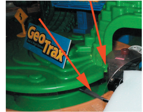
le fil d'alimentation n'est pas branché au tunnel
